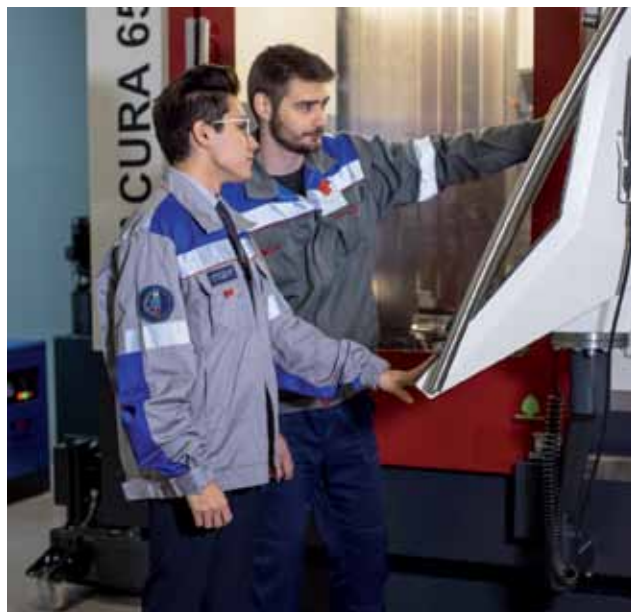
Гордостью Академии является уникальный фрезерный обрабатывающий центр HEDELIUS ACURA 65 с одновременным фрезерованием по 5 осям (Германия)
