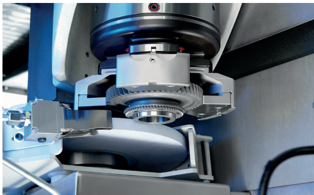
Рис. 3. Токарно-шлифовальный центр VLC 200 GT: шпиндель для наружного шлифования
