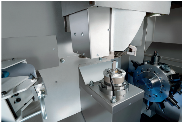
Рис. 2. Гибкая наладка: рабочая зона VLC 200 GT может быть оснащена 12-позиционной револьверной головкой и шпинделями для внутреннего и наружного шлифования
