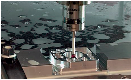
Рис. 20. Процесс измерения детали системой Renishaw
