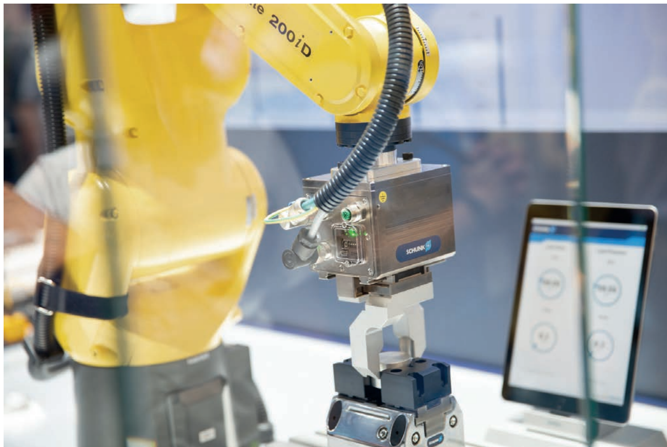
Рис. 7. «Умные» зажимные устройства и системы позволяют измерять, идентифицировать и контролировать зажатые компоненты и текущий производственный процесс в режиме реального времени
