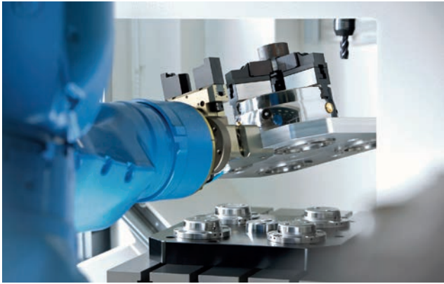
Рис. 5. При обработке малых и средних партий система быстрой смены паллет SCHUNK VERO-S NSA plus обеспечивает высокую надежность, гибкость и эффективность технологического процесса
