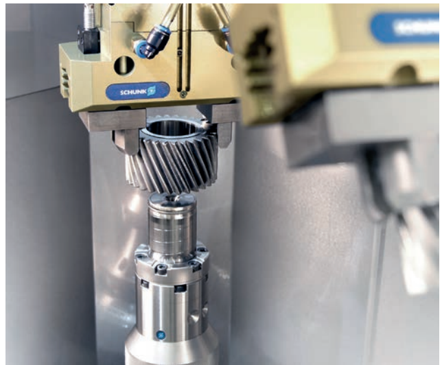
Рис. 1. Оптимизированная по весу конструкция токарного патрона позволяет снизить инерцию SCHUNK ROTA NCE на величину до 40%. В частности, в серийном производстве токарный патрон являет собой впечатляющую демонстрацию высоких динамических характеристик, низкой себестоимости и эффективности использования электроэнергии
