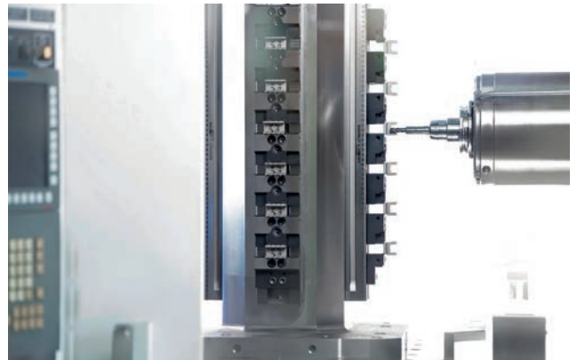
Рис. 4. Многоместные зажимные тиски SCHUNK KONTEC KSM обеспечивают множество решений по зажатию серийных деталей, при этом быстро и легко настраиваются
