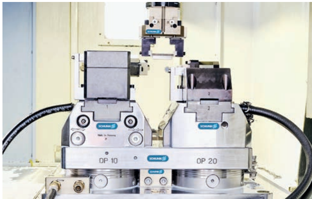
Рис. 3. Силовые зажимные блоки SCHUNK TANDEM plus с большим усилием зажима были специально разработаны для соблюдения требований по автоматизированной загрузке станка. В этом компактном решении по автоматизации они объединены с зажимной станцией SCHUNK VERO-S NSL3 и загружаются с помощью собственных осей станка
