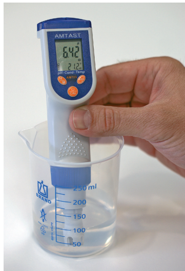
Рис. 3. Портативный прибор для измерения pH, электропроводности и TDS
