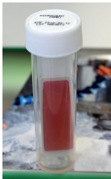
Рис. 4. Погружной слайд для измерения количества бактерий и грибов
