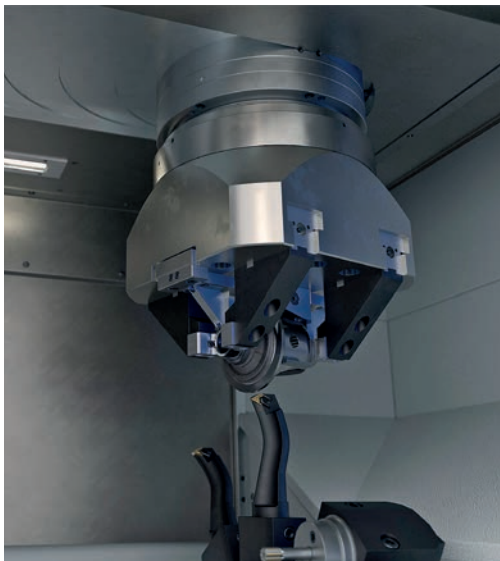
Рис. 3. Компания EMAG также самостоятельно разрабатывает и производит специальные зажимные приспособления. В данном случае для токарного станка VL 6 на OP 40
