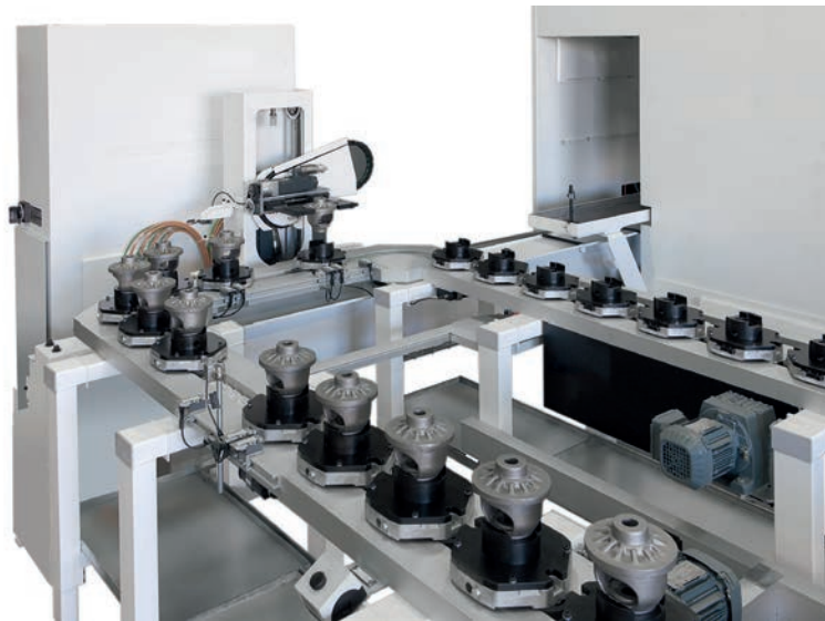
Рис. 4. В системе автоматизации EMAG TrackMotion транспортный модуль с подъемным устройством и программируемым электрическим грейфером перемещается по рельсовой направляющей (Track) между станками
