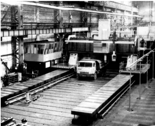
Рис. 2. Расточный станок модели LR367F4 (Ленинградское станкостроительное объединение им. Свердлова «Лен СТО»)
