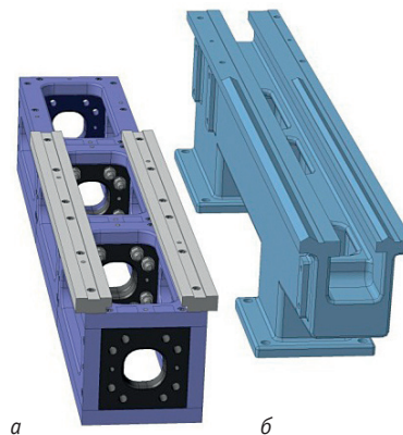
Рис. 4. Трехмерная электронная геометрическая модель (твердотельная модель): а – фрагментированная сборка станины станка ТВ-3, б – литая станина станка ТВ-3
