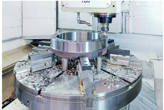
Рис. 2. Компания ROLLSTAR применяет патрон SCHUNK ROTA NCR 1250 для фиксации обрабатываемых деталей редукторов, которые не терпят даже малейшей деформации. Благодаря этому точность обработки оказывается гораздо выше, чем при использовании обычных трехкулачковых патронов
