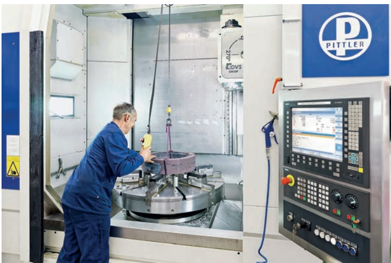
Рис. 8. Загружаемая в станок заготовка сначала ставится на специальные опоры. Это обеспечивает оптимальную ориентацию всех шести кулачков патрона
