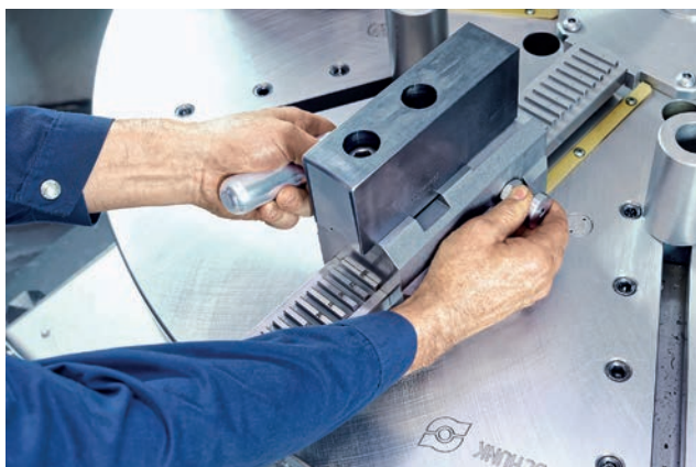
Рис. 6. Система быстрой смены кулачков позволяет менять заранее настроенные базовые и накладные кулачки за несколько простых движений. Точность позиционирования кулачков можно контролировать по встроенной шкале
