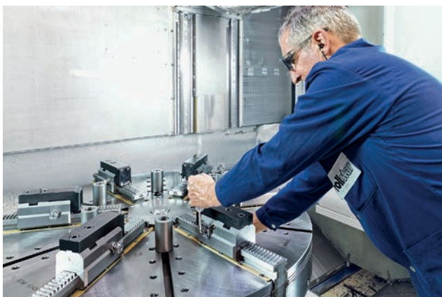
Рис. 5. Система быстрой смены и настройки кулачков, наладка станка занимает не более 20 мин
