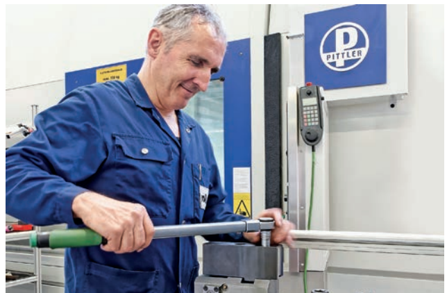
Рис. 3. Оператор станка Вилли Уммель настраивает второй набор кулачков, не дожидаясь полной остановки станка
