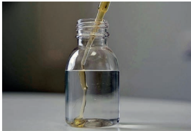
Рис 4. Концентрат поступает в воду без перемешивания
