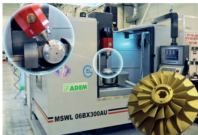
Рис. 2. 4-координатное плунжерное фрезерование моноколеса (титан)
