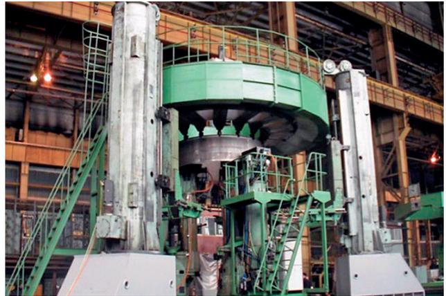
Рис. 7. Специальный фрезерный станок с ЧПУ мод. СВО 25
