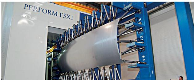
Рис. 5. Общий вид станка мод. PERFORM F5X1 с панелью аэробуса, подготовленной для зеркального фрезерования
