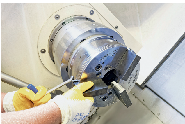
Рис. 9. Заранее подготовленные кулачки для механизированного патрона SCHUNK ROTA THW plus 260 меняются с высокой точностью всего за несколько простых действий
