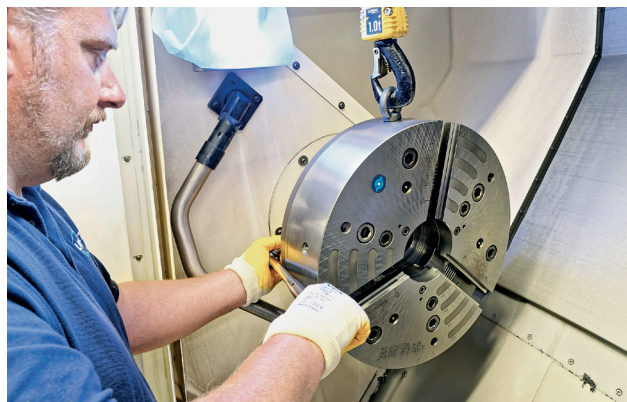
Рис. 2. Фиксация патрона в системе быстрой замены SCHUNK ROTA FSW обеспечивается всего одним болтом. С его помощью система автоматически центрирует корпус патрона
