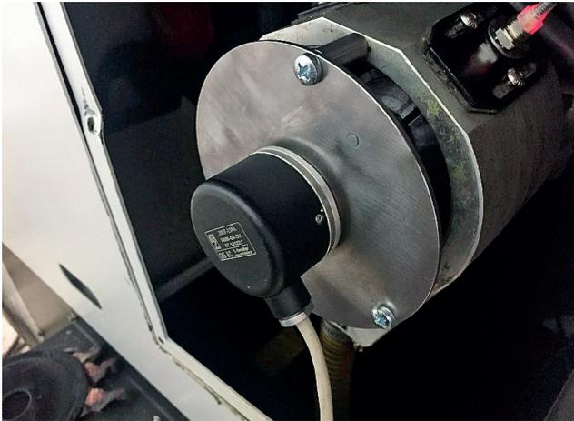
Рис. 3. Установка фазохронометрического датчика на станок
