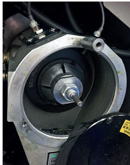
Рис. 2. Оснастка, установленная на шпиндель станка
