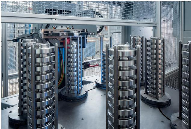
Рис. 3. Система автоматизации TrackMotion позволяет использовать вертикальные штыревые палеты, на которых можно максимально компактно разместить большое количество заготовок
