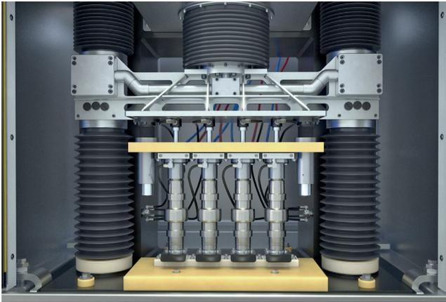
**Рис. 9.** Покупателям установки PI 800 предлагается на выбор два обрабатывающих модуля: модуль прецизионной электрохимической обработки (РЕСМ) с осцилляцией или опускающийся модуль для ЕСМ-обработки, оба модуля можно использовать для одновременной обработки нескольких одинаковых деталей
