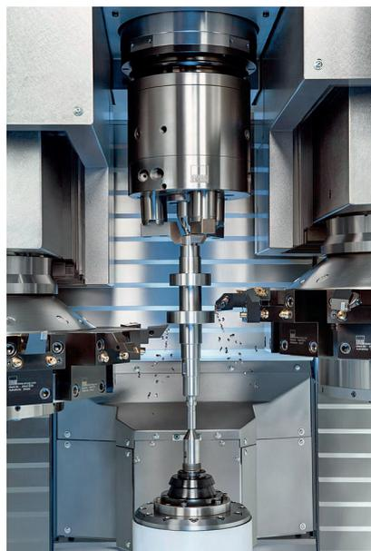
Рис. 6. Серия VT: 4-осевая обработка крупных партий валов коробок передач
