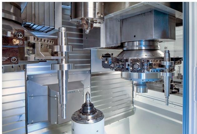
Рис. 7. Загрузка заготовок и выгрузка обработанных деталей осуществляется при помощи грейферов, установленных в обеих револьверных головках. Подача и отвод деталей обеспечивается боковыми автоматическими транспортерами-накопителями
