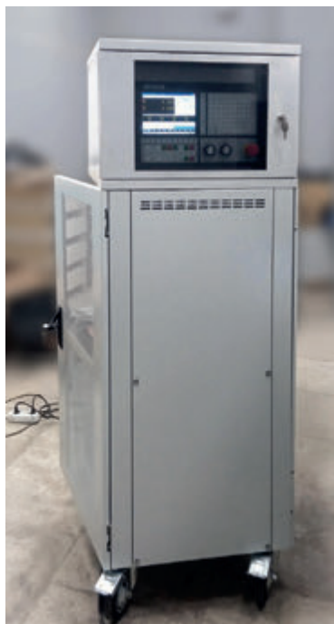
Рис. 3. Электрощкаф с системой ЧПУ
