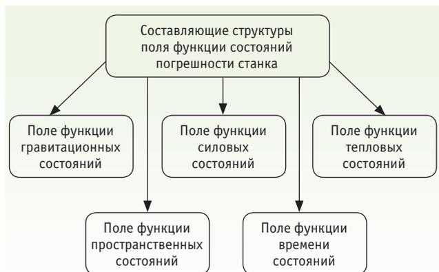
Рис. 3. Составляющие функции состояний погрешностей станка
