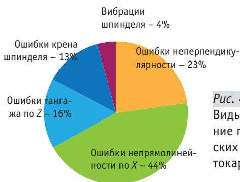
Рис. 4. Виды и соотношение геометрических погрешностей токарного станка
