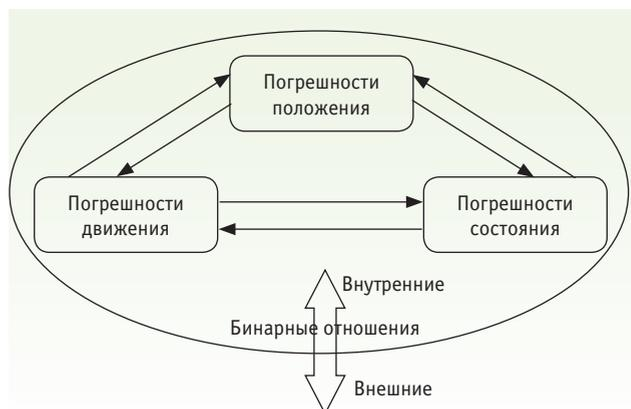
Рис. 2. Система погрешностей металлорежущего станка по причине их возникновения
