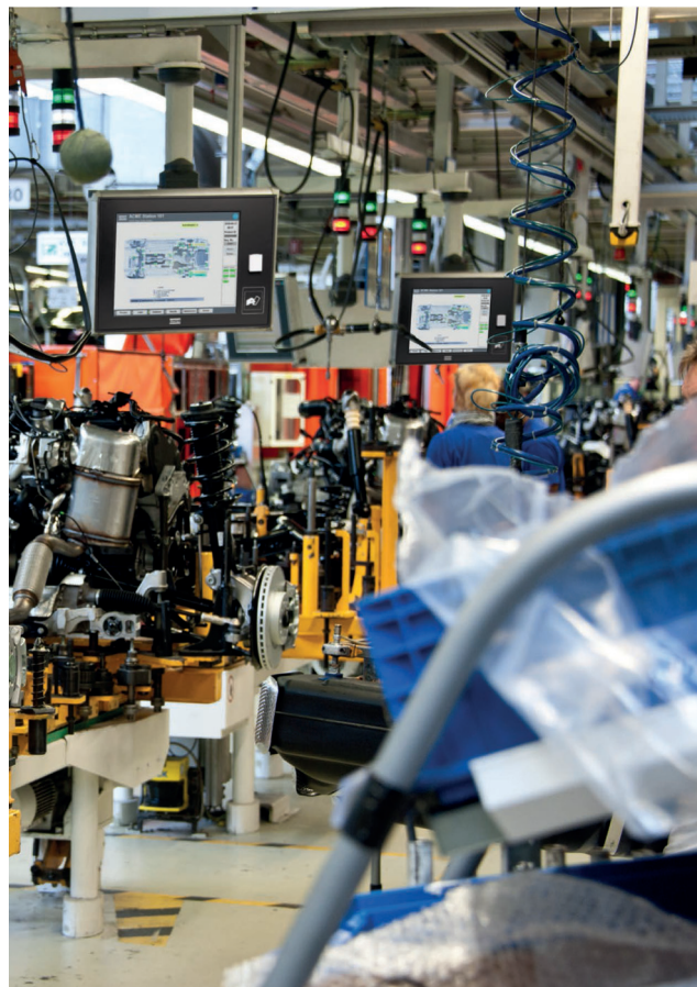
Рис. 9. Интеллектуальные гайковерты компании Atlas Copco на автосборочном конвейере
