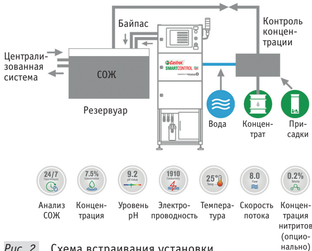
Рис. 2. Схема встраивания установки SmartControl в технологическую линию
