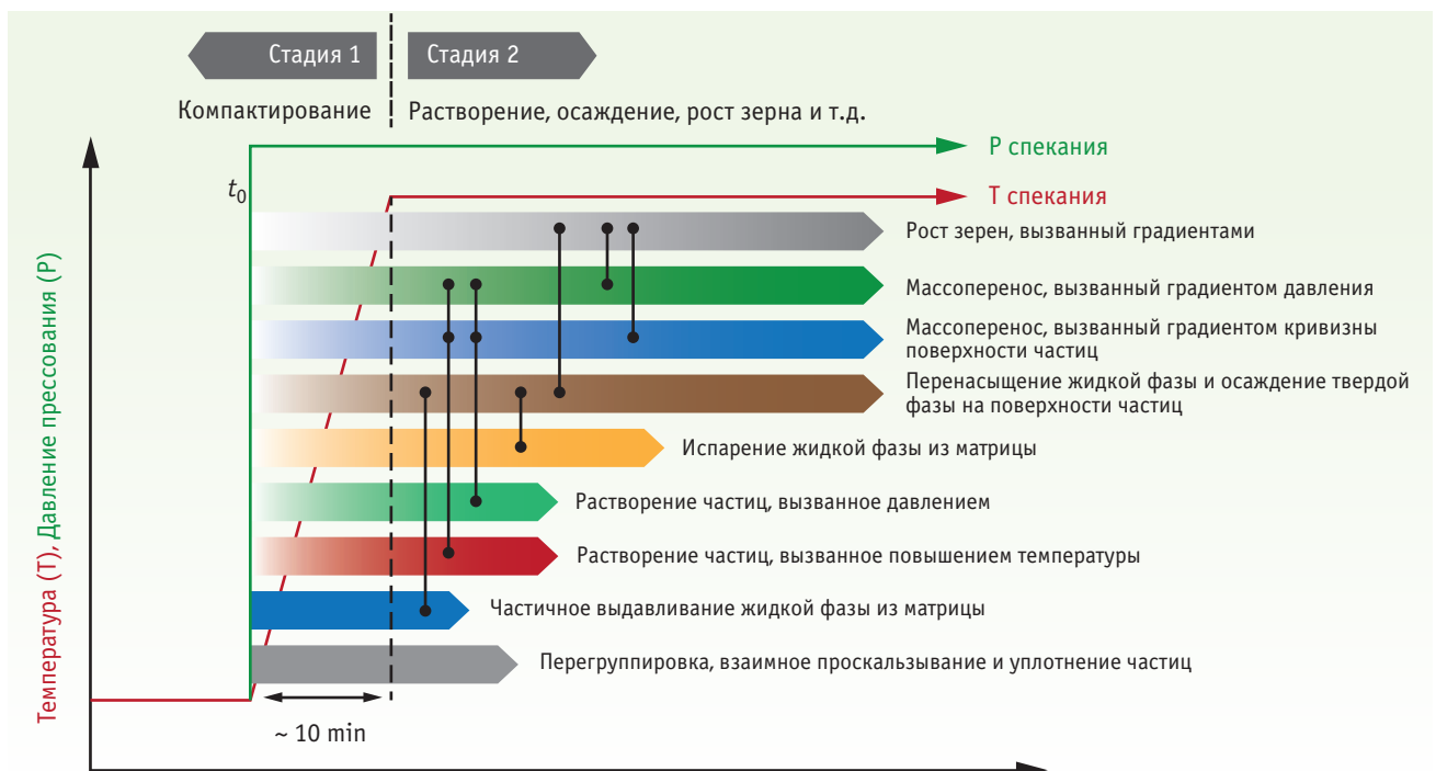
Рис. 3. Схематическая иллюстрация составляющих механизма процесса холодного спекания. Вертикальные черные линии указывают на взаимосвязанные процессы, по материалам [9]
