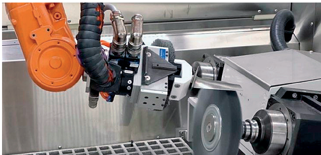
Рис. 1. Обработка с закреплением заготовки на роботе
