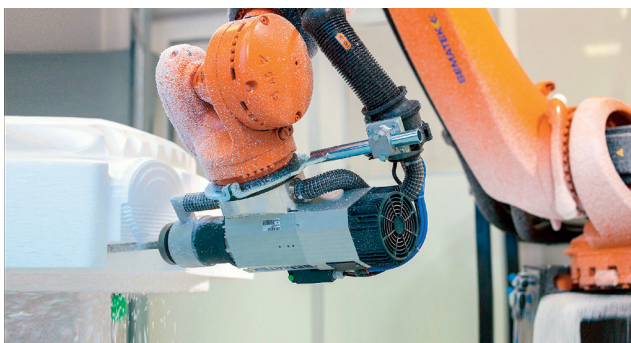
Рис. 2. Обработка с закреплением инструмента на роботе
