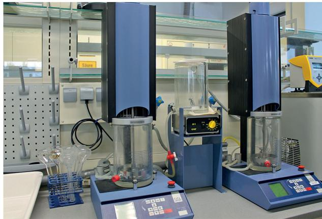
Рис. 4. Установки SITA Foam tester
