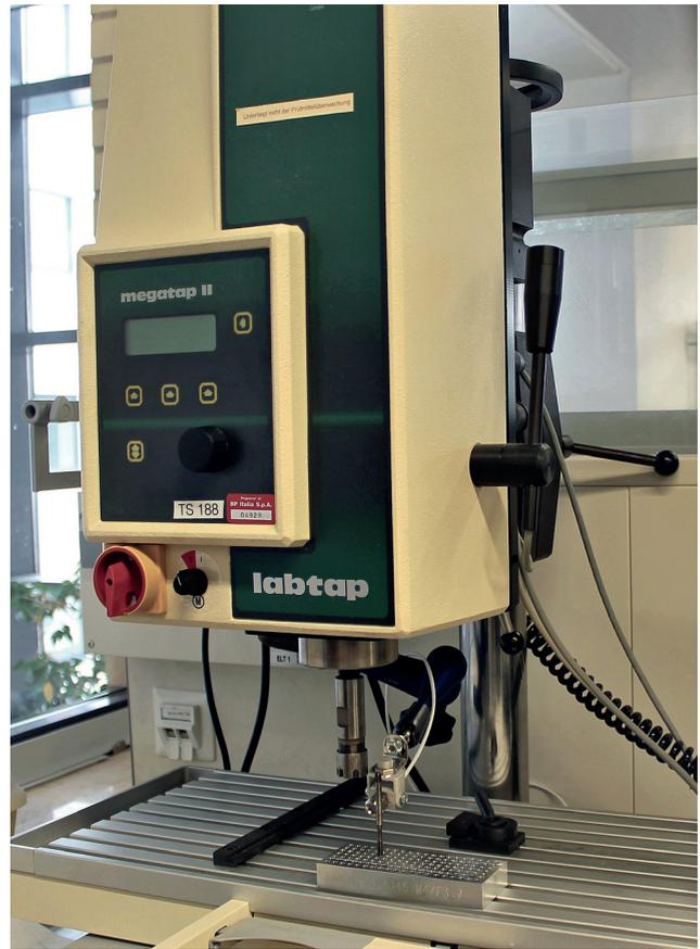
Рис. 6. Установка для измерения крутящего момента при нарезании резьбы
