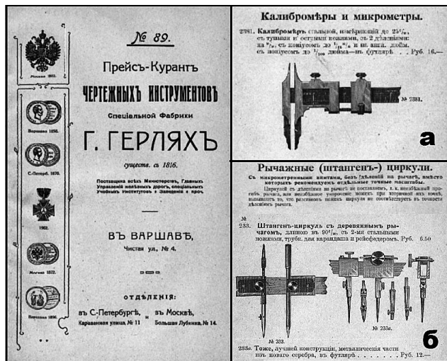
Рис. 5. Данные из прейскуранта фабрики «Г. Герлях»: а – калибрмер, его внешний вид, описание и стоимость; б – то же для рычажных циркулей (штангенциркулей)
