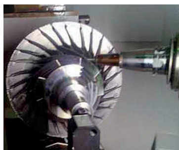
Рис. 5. Обработка импеллера из титана марки VT25Y
