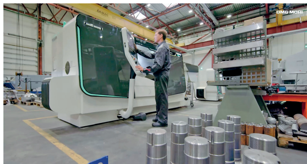
Рис. 2. На токарном станке CTX 510 ecoline производства Ульяновского станкостроительного завода DMG MORI изготавливаются детали, требующие высочайшего качества поверхности
