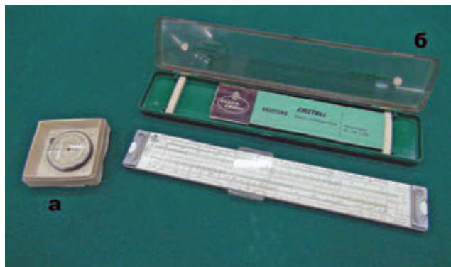
Рис. 4. Модели логарифмических линеек: а – круговая линейка КЛ-1, СССР, 1962 г.; б – модель Novo-Duplex2/83N фирмы Faber-Castell, одна из лучших последних логарифмических линеек в мире (31 шкала), до 1976 г.
