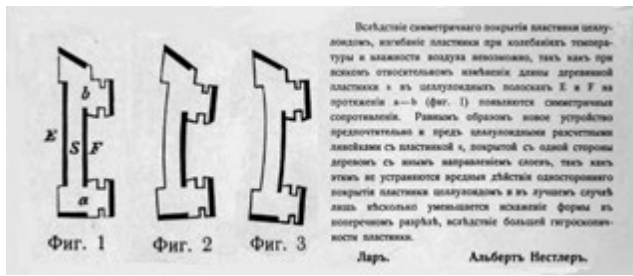
Рис. 10. Изменение в технологии изготовления линеек на примере продукции фирмы Albert Nestler, г. Лар, Германия, 1904 г.
