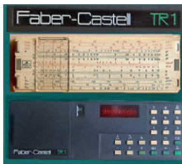
Рис. 5. Гибрид калькулятора и логарифмической линейки Faber-Castell TR-1, 1973 г.
