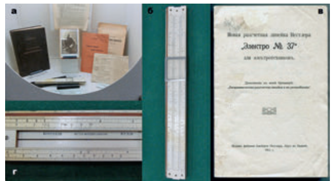
Рис. 9. Линейка для электротехнических расчетов: а – витрина музея с экспонатами, посвященными деятельности профессора К.А. Круга; б – линейка «Электро № 37» фирмы Albert Nestler, с 1911 г.; в – брошюра с указаниями по применению устройства; г – логотип фирмы-производителя
