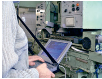
Рис. 7. Исследование температурных полей образца термографом ИРТИС-2000
