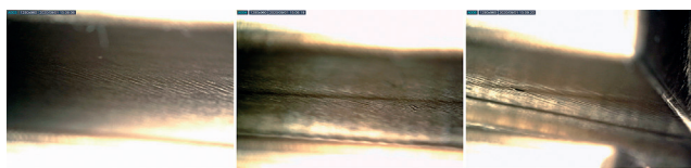
Рис. 8. Качество обработанной поверхности у варианта D10B оказалось лучше
