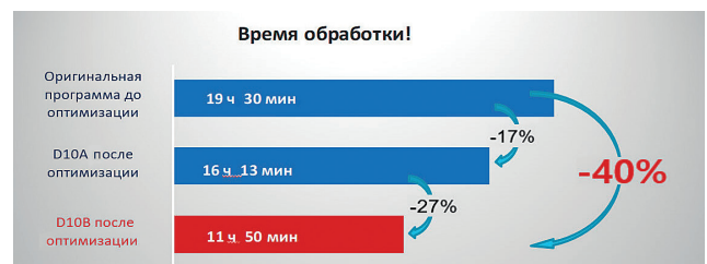
Рис. 5. Сравнение времени обработки, выигрыш 17 и 40% от оригинальной программы!
