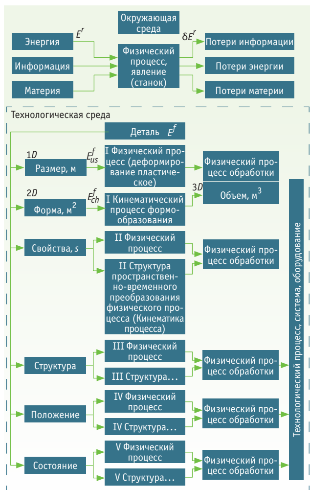
Рис. 4. Энергоинформационная модель технологического оборудования
