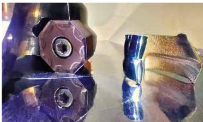
Рис. 3. Качество поверхности после фрезерования новой фрезой
