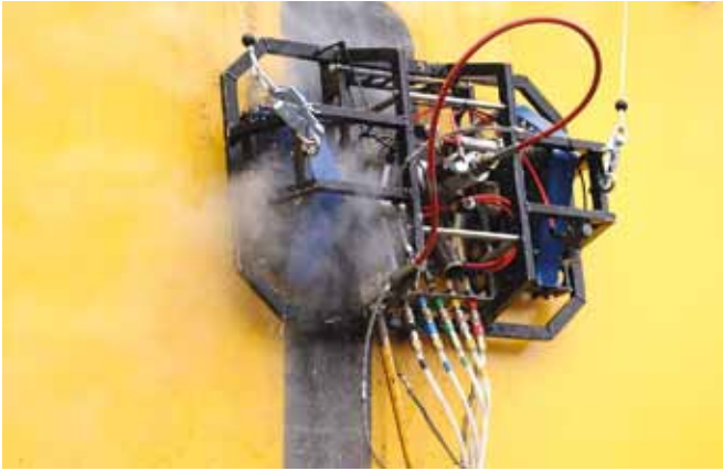
Рис. 1. МРК M250, перемещающийся по ферромагнитной поверхности. Источник http://www.jetstreameurope.co.uk
