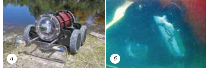
Рис. 2. МРК Hull BUG фирмы ONR Discovery: а – внешний вид; б – работа аппарата под водой. Источник https://www.automate.org/tech-papers/hull-cleaning-robot-for-large-ships
