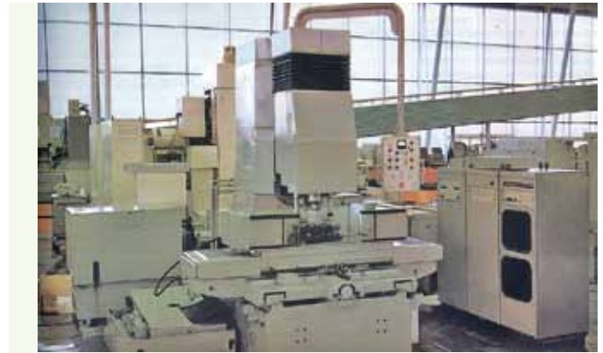
Контурно-шлифовальный станок с ЧПУ МА396ФЗ «ЭНИМС» – «Станкоконструкция». Был разработан для изготовления роторно-поршневой группы двигателя Ванкеля и других деталей сложной формы
