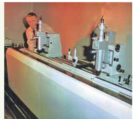
Лазерный компаратор МС-18МК. Изделия высочайшей точности, работавшие в подземном термостатном корпусе и обеспечивавшие изготовление и контроль изделий с субмикронной точностью
