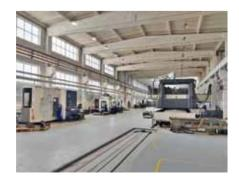
Изготовлены полы с износостойким покрытием, оштукатурены и окрашены стены. Установлен новый мостовой кран. Выполнено энергоснабжение и освещение.
