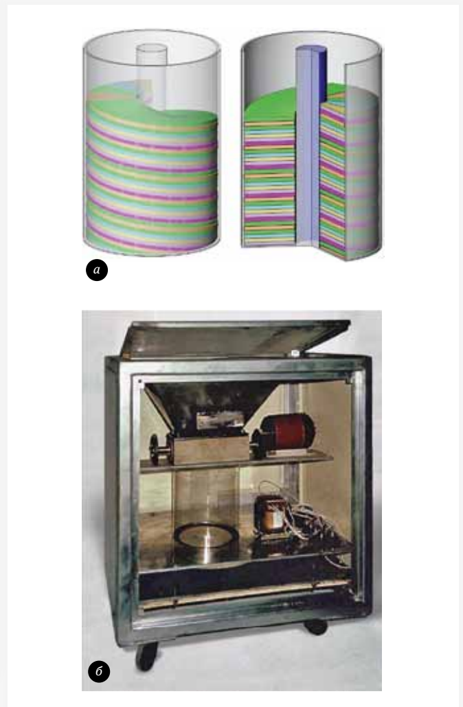
Рис. 2. Схема получения упорядоченной структуры смеси или композита (а) на двухпозиционном роторном немиксере (б)
