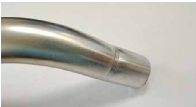
Рис. 2. Дефект в виде вмятины от переднего стального прижима
