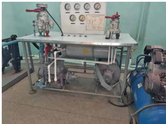
Рис. 3. Испытательный стенд тормозной системы грузового вагона, собранный с применением гибких труб (МКУТ)
