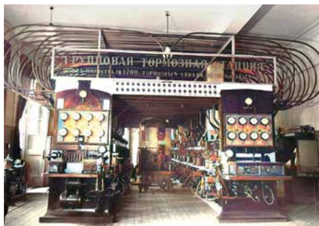
Рис. 2. Фотоснимок групповой тормозной станции кафедры «Вагоны и вагонное хозяйство» РУТ(МИИТ)
